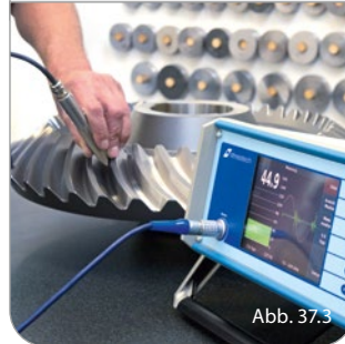
Schleifbrandprüfung (Barkhausenrauschen) Barkhausen Noise Analysis (BNA)
