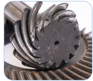
verschlissener Radsatz / worn gear set
