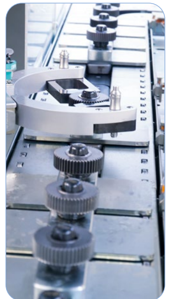
Automatische Beladung einer Wälzschleifmaschine / automatic loading of a gear grinding machine
