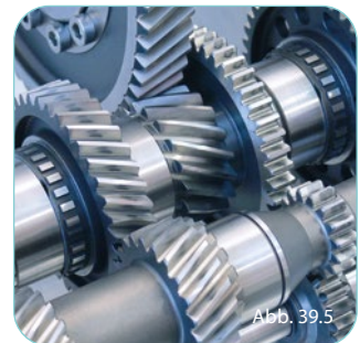
Gangradsatz für Lancia Stratos / gearwheel set for a Lancia Stratos
