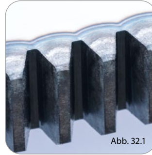
Induktionshärten / induction hardening
