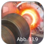
Induktionshärten / induction hardening
