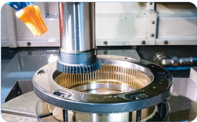
Stoßmaschine / shaping machine
