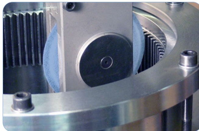
Innenverzahnung mit Schleifscheibe / internal gearing with grinding
